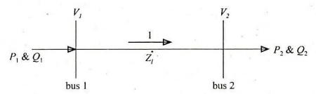
ऊपर चित्र में,  $V_1=1 \angle 0^\circ$ ,  $Z_I=(0.05+j\ 0.02)$  pu और  $P_2+jQ_2=(1.0+j\ 0.6)$  pu है । भार प्रवाह अध्ययन का उपयोग करते हुए पारस्परिक तौर पर  $V_2$  और  $P_1+jQ_1$  की गणना कीजिए ।  $|V_1|=|V_2|=1.0$  pu को बनाए रखने के लिए bus 2 में आवश्यक तौर पर संरोपित की जाने वाली क्रियाशील शक्ति का भी निर्धारण कीजिए ।
